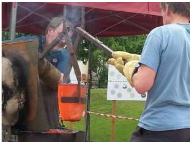
Sie heben den Schmelztiegel mit der brodelnden rotglühenden und rauchenden Schmelze aus dem Ofen heraus, treten damit an die Form und füllen dann langsam und gleichmäßig gut 15 Kg flüssiges Metall in die Einfüllöffnung der Form.
